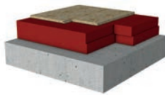
Dämmung oberste Geschossdecke
