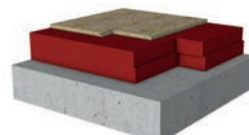
Dämmung oberste Geschossdecke
