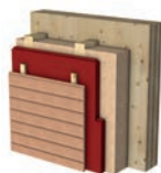
Hinterlüftete Fassade regensicher
