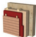
Hinterlüftete Fassade regensicher
